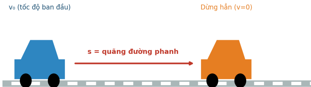
Hình 12.1: Quãng đường phanh xe tăng theo bình phương tốc độ ban đầu.
